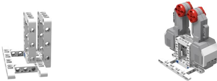
(2) 第二步，电机用长销固定上，再通过 4 个带孔臂扩展出 2 个“翅膀”的结构，电机转动就带动“翅膀”上下运动，如下图所示：
