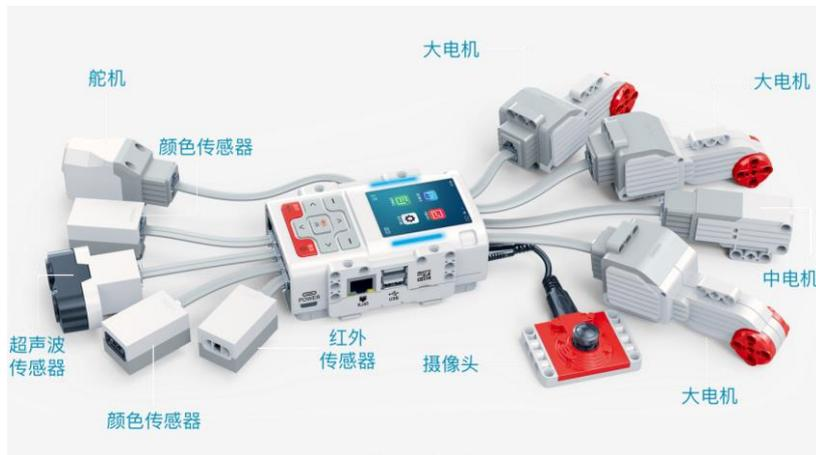
图表 2-8 连接电机，舵机，摄像头和各种传感器的主机
