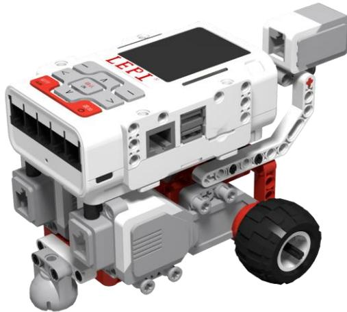
图表 4-75 带红外颜色传感器的小车
