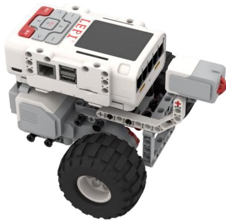
图表 4-47 带触碰传感器的小车
