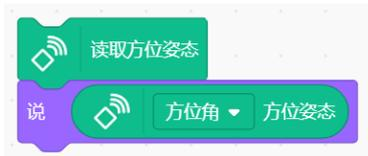
(2) 根据读到的“方位角”数据信息，做转动控制，若方位角大于 195 度，则控制电机反转；若方位角小于 165 度，则控制电机正转，如果大致在 180 度左右，电机就不动。
