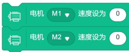
这样小车就可以往前行驶一定距离了，值得注意的是，因为小车行驶的距离受多方面因素的影响，如各种型号车轮半径及电机功率等，因此在程序中并没有直接设定小车行驶的距离的指令，只能设置电机的速度和时间来让小车行驶一定距离，且行驶的距离还会受到左右轮半径，小车重量，地面摩擦力等的影响，我们在实际操作过程中可参考示例程序，调整参数，使小车行驶更加贴合挑战的要求。对于小车而言，电机速度越大，相同时间内行驶更远，时间越长，相同电机速度行驶更远。
