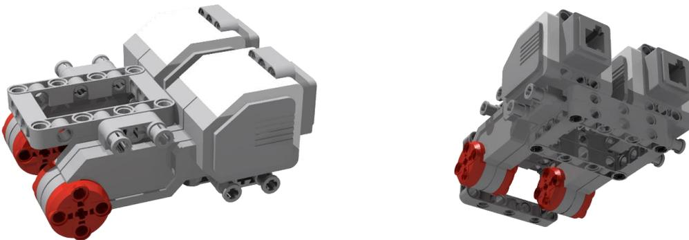
(2) 第二步，在前面步骤上安装上履带轮和履带，并扩展一些孔臂准备固定电机等外设，如下图所示。
