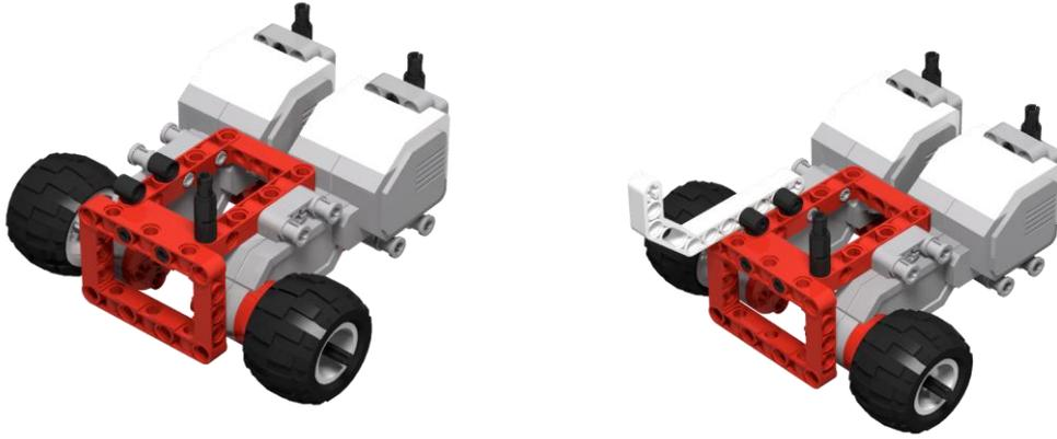
(3) 第三步，在前面基础上，把乐派主机和颜色传感器固定到插销上，如下图所示。
