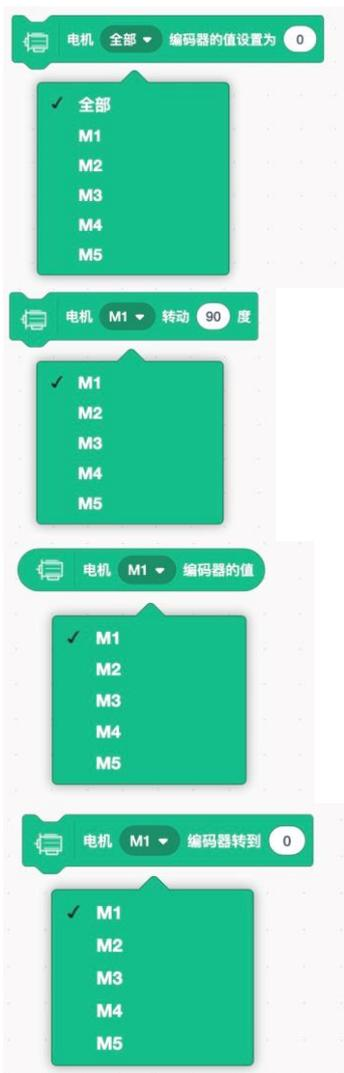
将全部接口的电机或者 M1-M5 中的某个接口的电机的编码器的值设为 0，电机向前/向后行驶一圈，编码器增加/减少 720。
