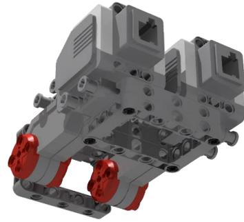
(2) 第二步，在前面步骤上安装上履带轮和履带，并扩展一些孔臂准备固定电机等外设，如下图所示。
