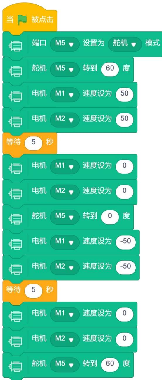
图表 4-40 无人车搬运完整程序
