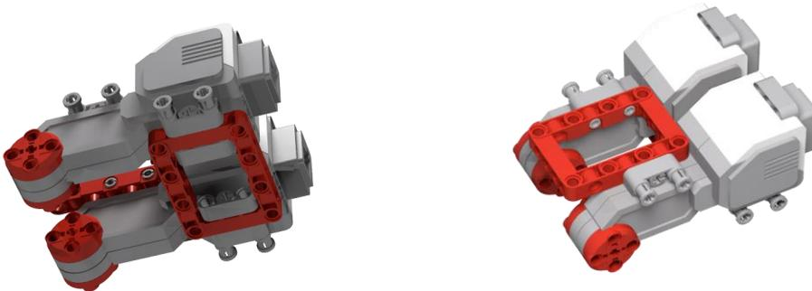
(2) 第二步，在前面步骤上加上万向轮机橡胶轮，及主机和双弯梁的固定销，如下图所示。
