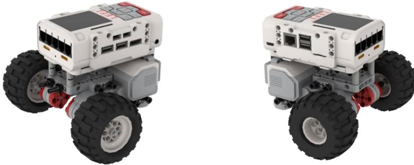
(4) 第四步，在前面基础上，舵机固定在小车的车头位置，如下图所示。
