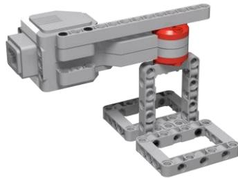
(2) 第二步，在前面步骤上加上固定主机的 3 x 5L 形梁，及主机的固定销。
