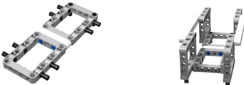
（2）第二步，基于框架结构，两端固定上 2 个长轴，并固定上履带轮，在履带
