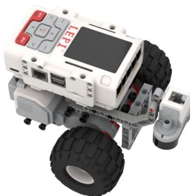
图表 4-67 带超声传感器的小车
