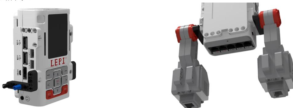
(2) 第二步，在主机上部用轴和销把弯臂和履带轮固定上，作为机器的手臂，如下图所示。
