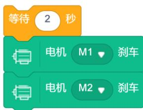
**注意：**小车向着电机速度比较小的电机方向转弯（比如左电机速度更小，小车向左转弯），小车转弯的速度跟电机运行的时间有关。运行时间越长转的角度越大。但是小车实际转弯的过程中，由于小车轮子的半径和地面摩擦力，积木搭建等综合影响下，不同小车在不同环境转弯 90 度的时间不一样，因此我们在编写程序的过程中，需要根据测试来调整小车转弯的时间。
