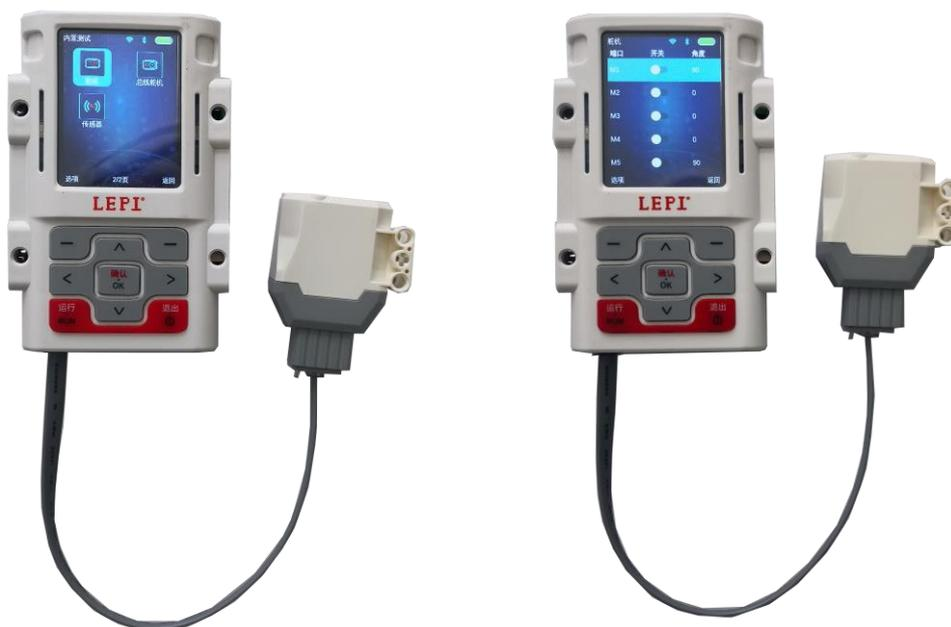
图表 2-20 主机接入 PWM 转向舵机的实物图
