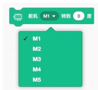
设置 M1-M5 某个接口的舵机转动的度数，可设置范围为 $-90^{\circ} \sim 90^{\circ}$ 。
