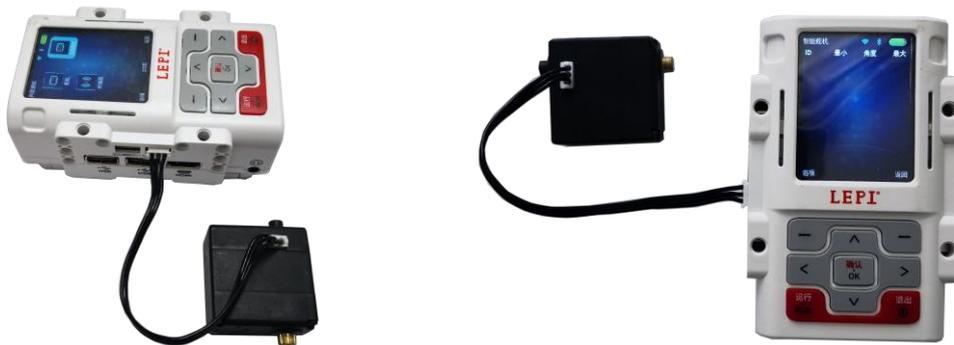
图表 2-23 主机接入总线舵机实物图
