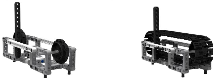
(3) 第三步，在履带的基础上，通过插销扩展孔壁，把摄像头和电机也固定在框架上，如下图所示：
