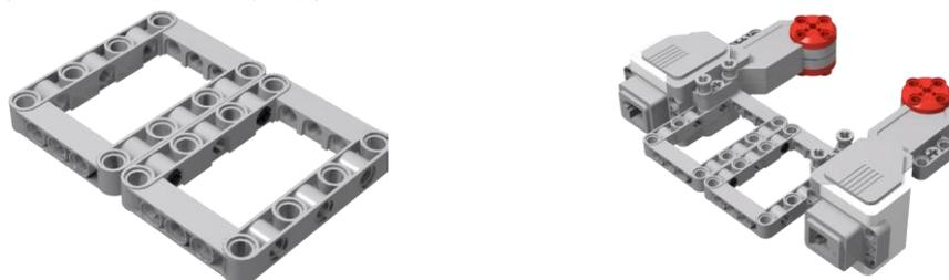
(2) 第二步，在电机的齿轮上扩展齿轮和 L 形孔壁，左右两边再固定上两个 5 x 7 口型梁作为开关门，如下图所示：
