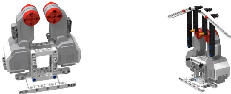
(3) 第三步，在“翅膀”上再固定上 2 个科技面板，让“翅膀”羽翼更丰满一些，再前面再通过插销把摄像头固定上，主机放在后面，这样不遮挡摄像头，如下图所示：
