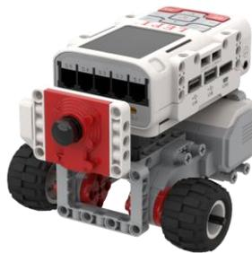
图表 6-62 基于视觉的标签检测小车
