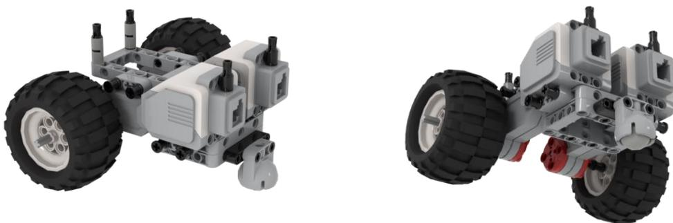
(3) 第三步，在前面基础上，把乐派主机和触碰传感器固定到插销上，如下图所示。
