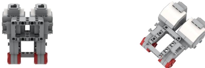
(2) 第二步，在前面步骤上加上万向轮机橡胶轮，及主机和双弯梁的固定销，如下图所示。
