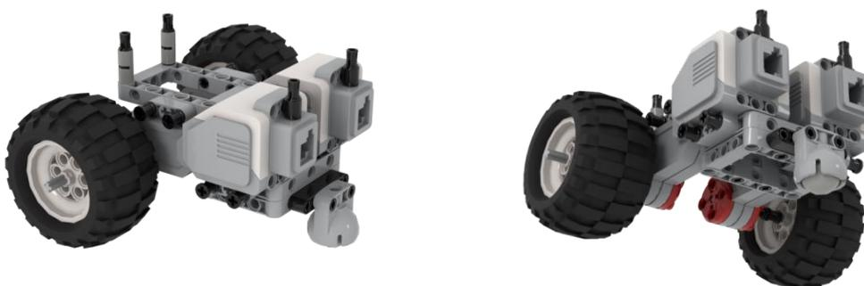
(3) 第三步，在前面基础上，把乐派主机和超声波传感器固定到插销上，如下图所示。
