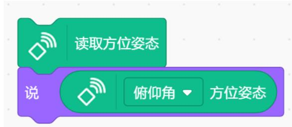
(2) 根据读到的陀螺仪的俯仰角信息，做平衡控制，若俯仰角大于 10，真正转动电机回正；若俯仰角小于 10，则控制电机反向转动回正，如果在这个角度之内，电机就不动，保持平衡。
