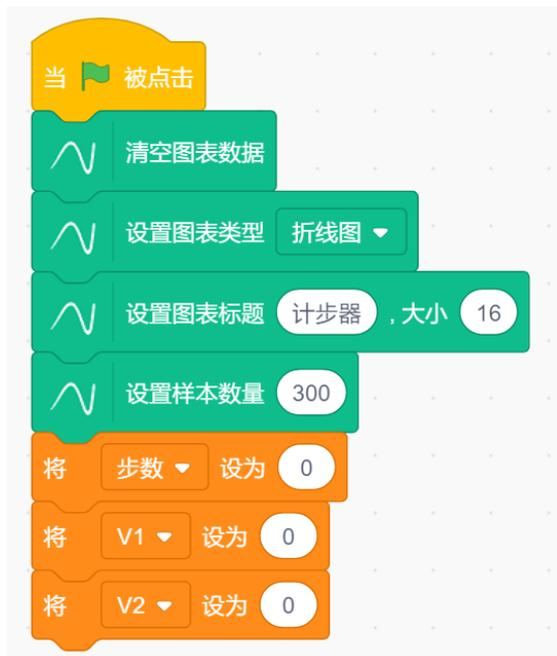
图表 4-135 基于三轴加速度的计步器初始化程序
