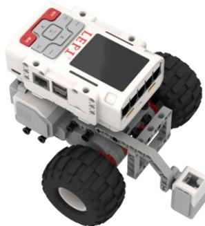
图表 4-81 带红外颜色传感器的小车
