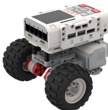
(4) 第四步，在前面基础上，中型电机在小车的车头位置，如下图所示。
