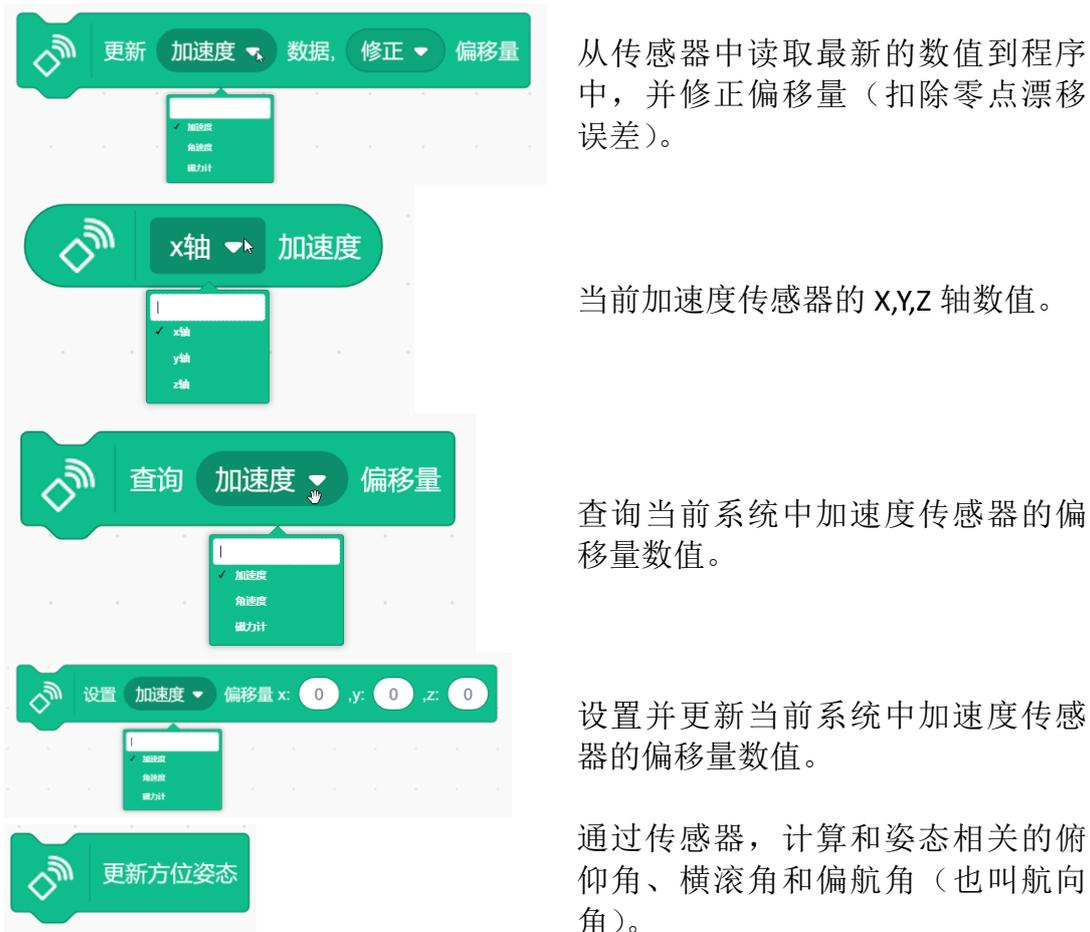
图表 4-124 三轴加速度传感器指令集
