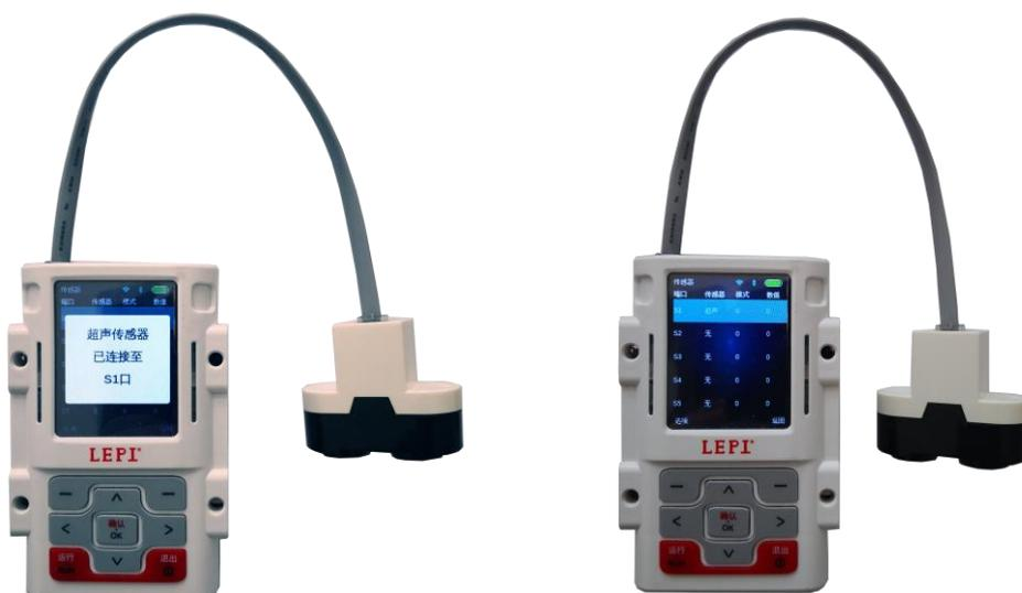
图表 2-21 主机接入超声波传感器实物图
