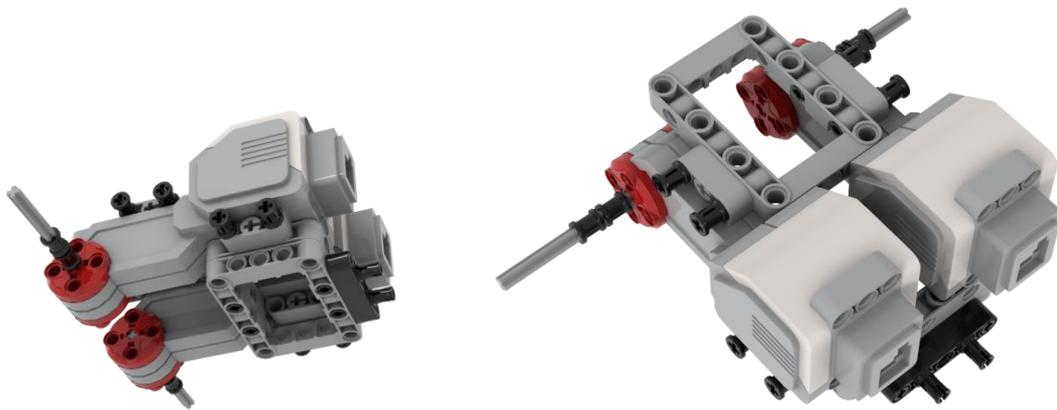
(2) 第二步，在前面步骤上加上万向轮机橡胶轮，及主机的固定销，如下图所示。
