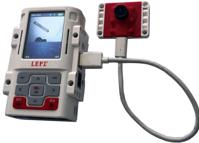
图表 2-22 主机接入摄像头实物图
