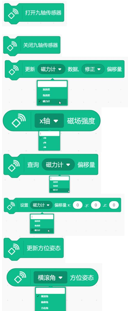
图表 4-173 三轴地磁传感器相关指令集
