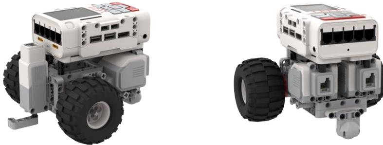
(1) 第一步，用两个 5 x 7 口型梁加上插销固定好两个电机，底部增加一个 5 x 7 口型梁以增加高度，如下图所示。
